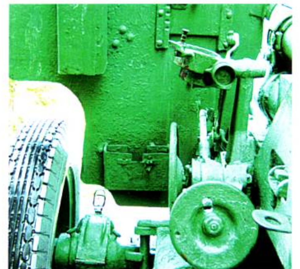
Внизу щита видна корзинка для аккумулятора послевоенной системы подсветки прицела «Луч»
