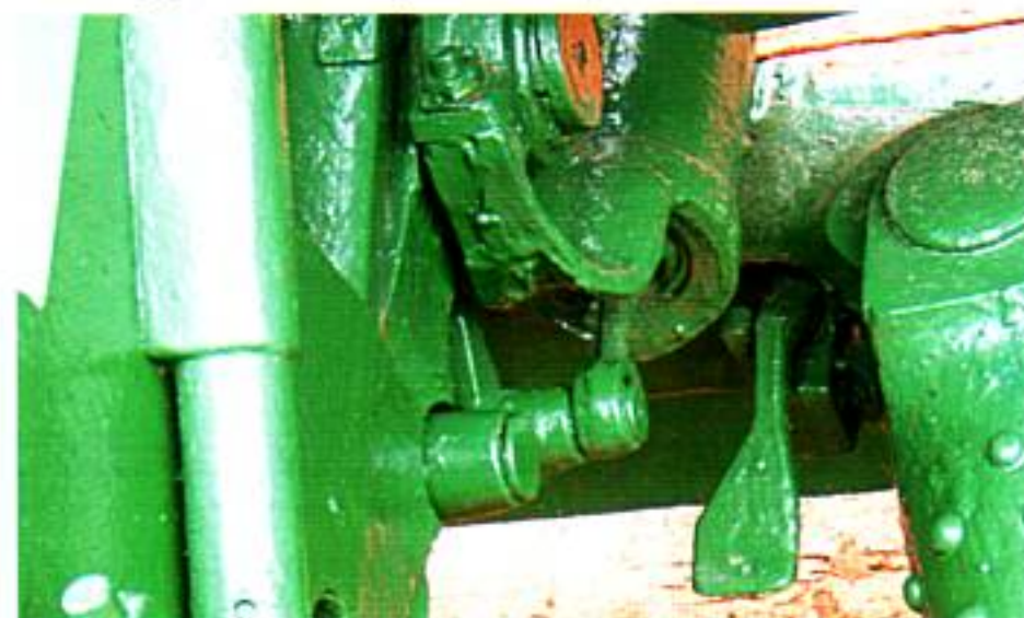
«Педаляка» фиксаторов станин на поздних орудиях со сварными станинами
