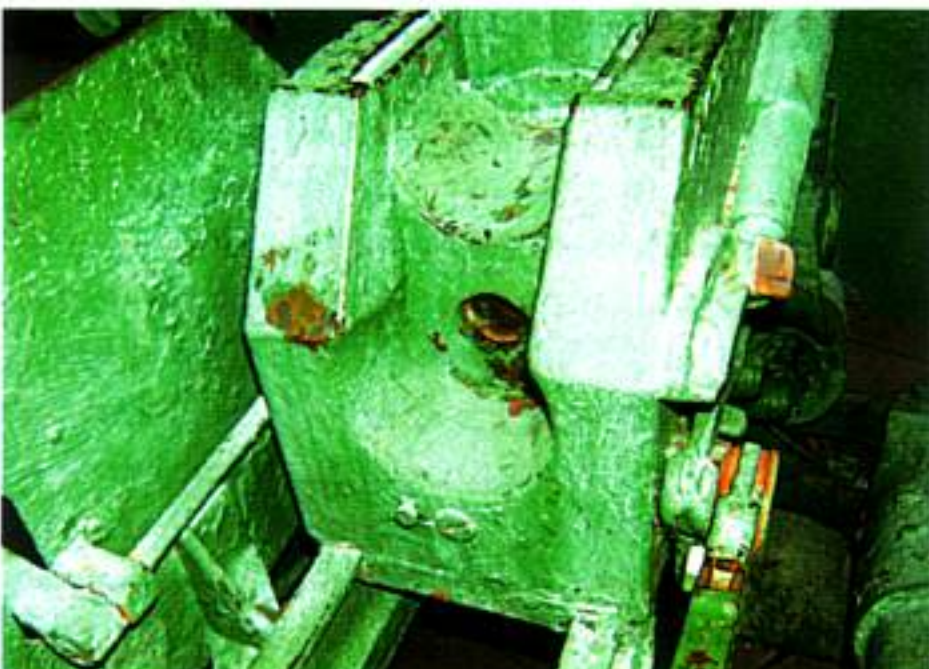
Затвор без среза в нижней части
