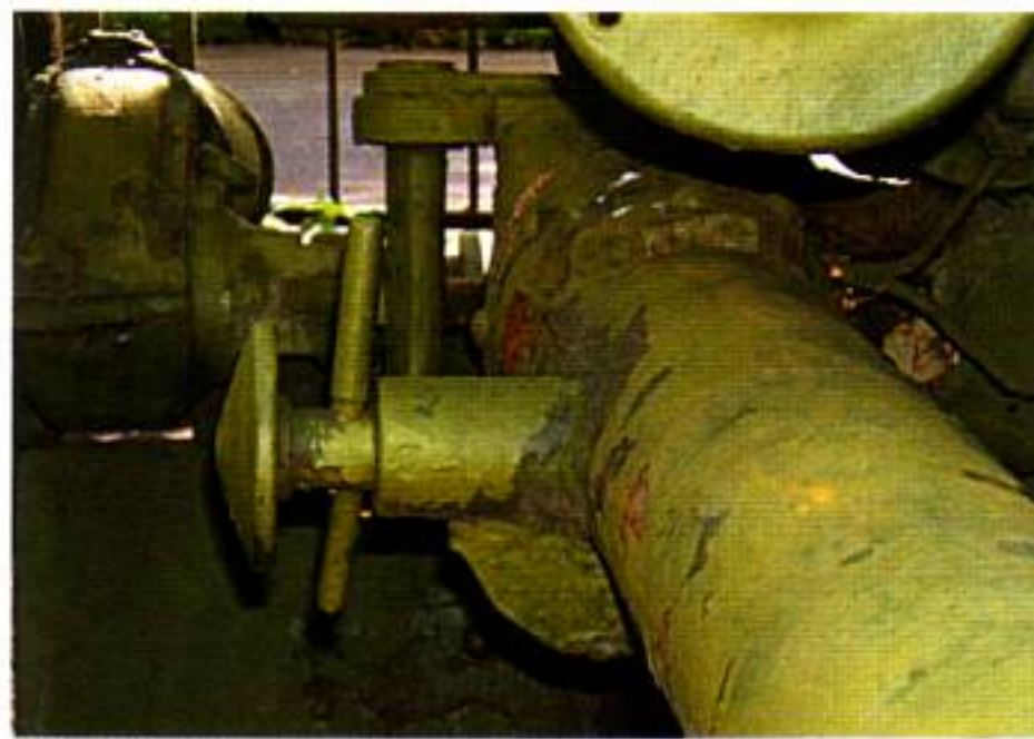
Тормоз колеса, закрепленный на станинах некоторых орудий
