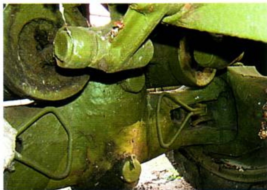
Орудие с поднятой высотой линии огня. Обратите внимание на треугольные рукоятки фиксаторов станин
